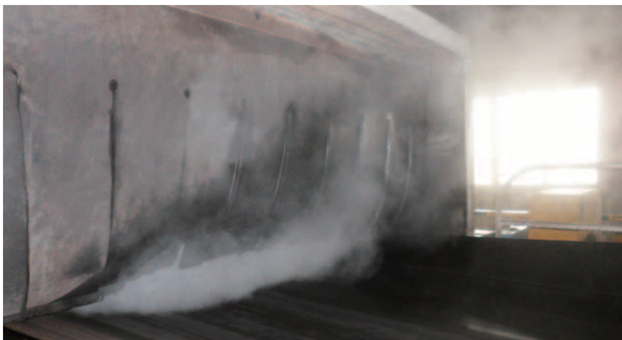
头部漏斗抑尘 Hopper Dust Suppression Device
