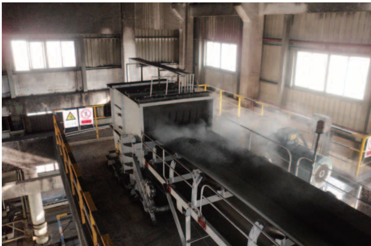
头部漏斗抑尘 Hopper Dust Suppression Device
